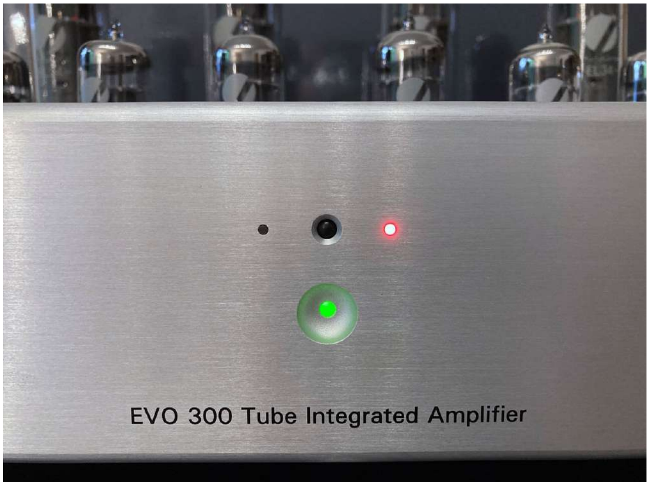
An den LEDs lässt sich ablesen, in welcher Betriebsart der PrimaLuna EVO 300 aktuell arbeitet – rot steht für Ultralinear, grün für Triode \
